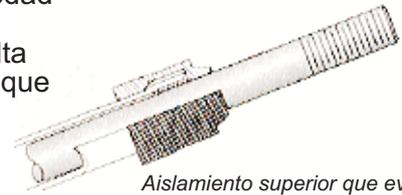
*Aislamiento superior que evita que la suciedad penetre en el interior del cable*
